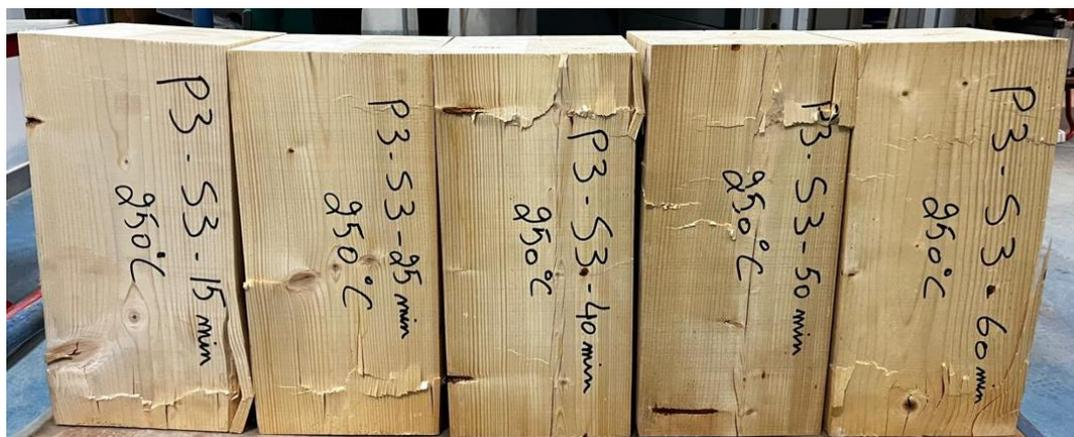
Figure 99 : Modes de rupture à 250°C pour la section S<sub>3</sub>
