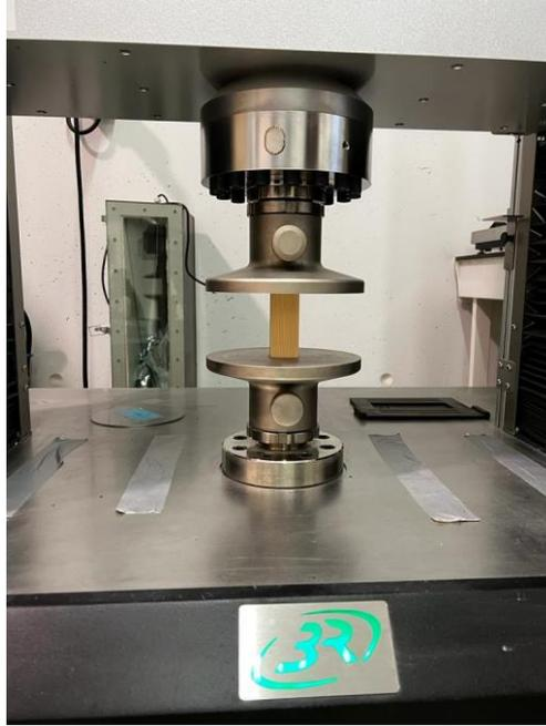
Figure 44 : Essais de compression sur le bois de sapin (section  $S_0$ ) réalisé à l'aide d'une presse électromécanique de marque 3R, d'une capacité de 300 kN.
