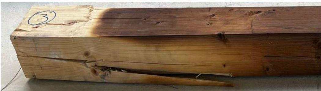
Figure 126 : Mode de rupture du poteau  $S_5$  chauffé à 250°C pour une durée de 60 minutes et refroidie pendant 24 heures
