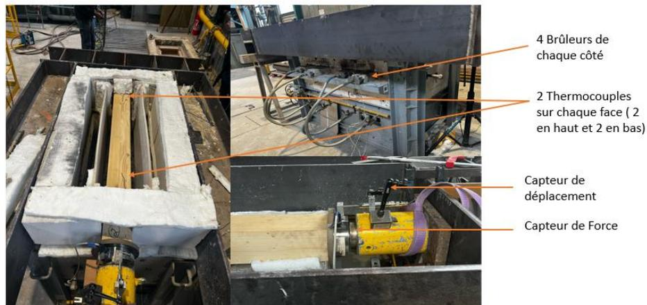
Figure 105 : Cellule d'essais
