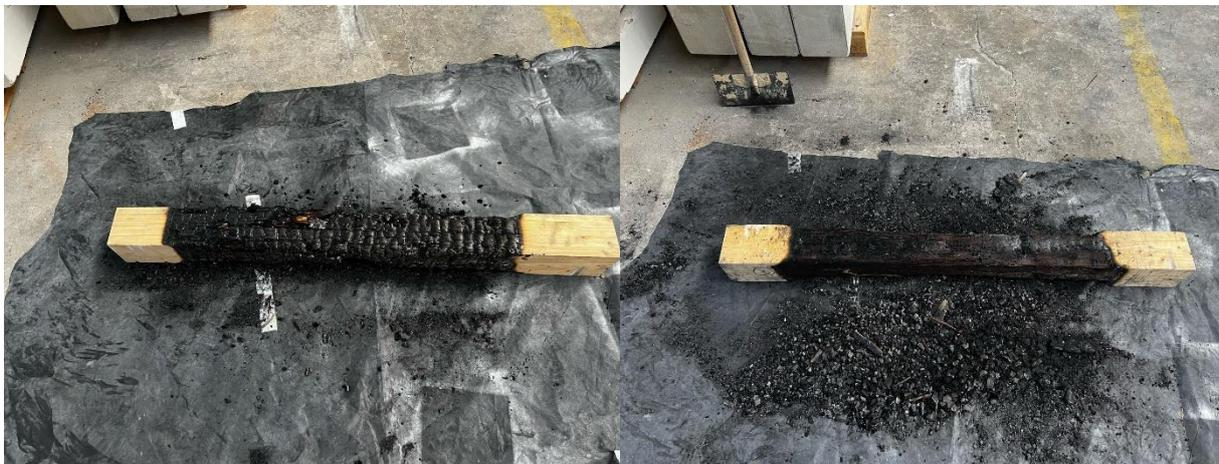
Figure 119 : Poteau S<sub>5</sub> après essai au feu et avant grattage    Figure 120 : Poteau S<sub>5</sub> après grattage et détermination de la section non carbonisée
