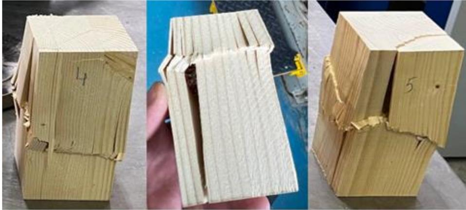
Figure 86 : Modes de ruptures des échantillons en compression pour des températures inférieures à 150°C
