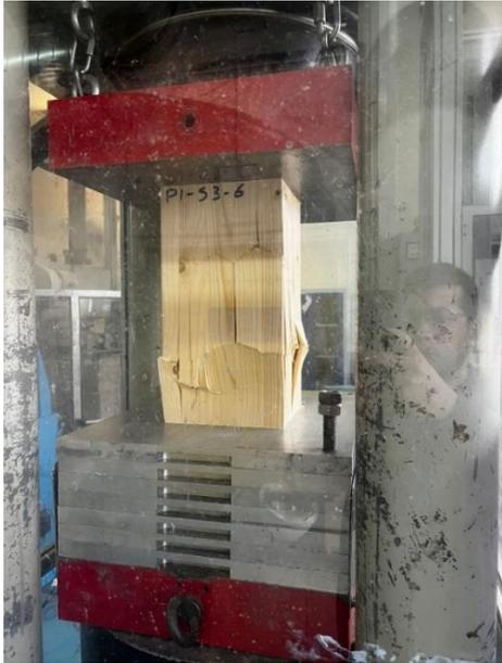
Figure 67 : Essais de compression réalisés sur une presse électromécanique de capacité 5000 kN
