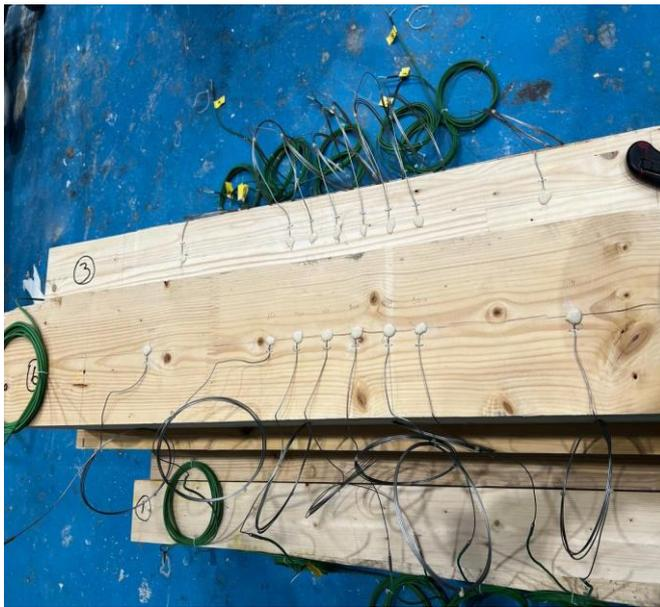
Figure 110 : Implémentation des thermocouples dans les poteaux
