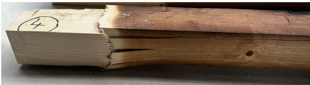
*Figure 127 : Mode de rupture du poteau S<sub>4</sub> chauffé à 250°C pour une durée de 60 minutes et refroidie pendant 24 heures*
