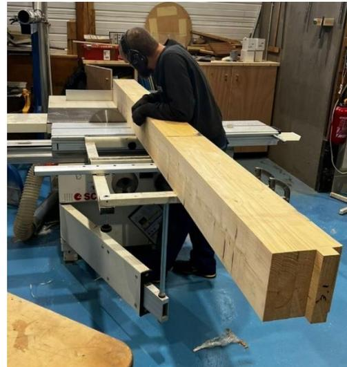
Figure 39 : Découpe des poutres lamellé-collé à l'aide d'une scie électrique
