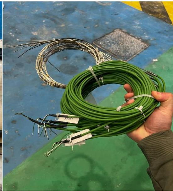
Figure 111 : Thermocouple de type « K » utilisés
