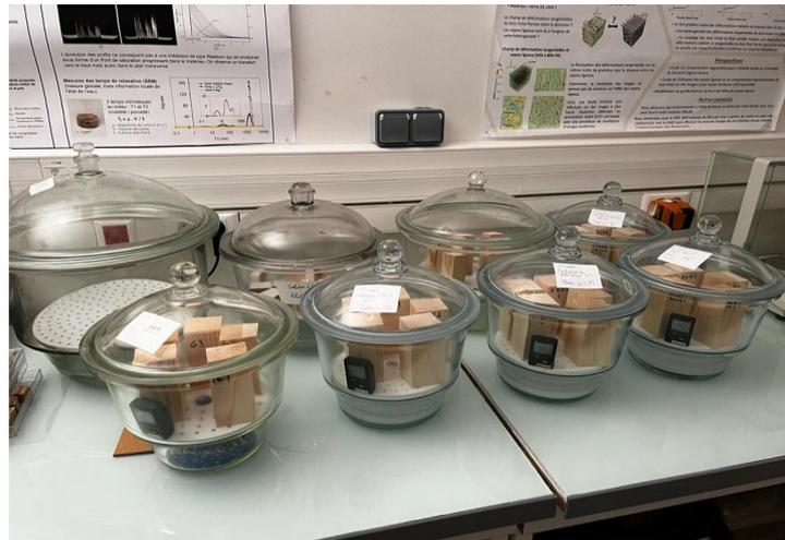
Figure 41 : Echantillons de bois de sapin de section  $S_0$  dans les dessiccateurs contenant différentes solutions salines saturées ou du gel de silice, à température ambiante 20°C
