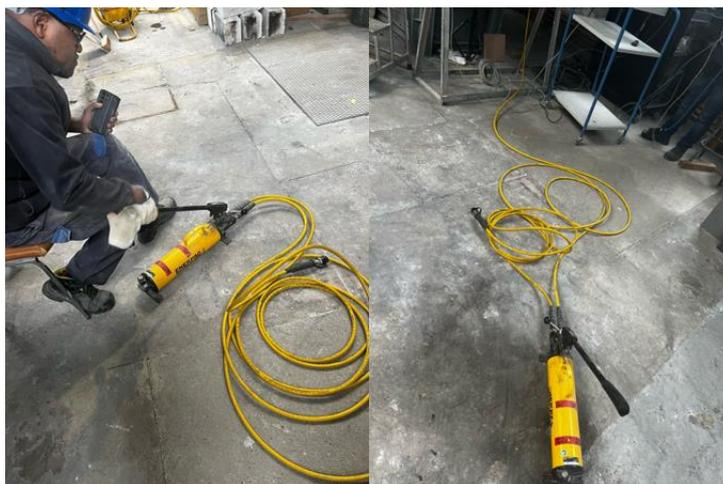
Figure 106 : Pompe hydraulique manuelle utilisée pour le chargement des poteaux
