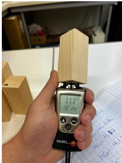
Figure 40 : Mesure de la teneur en eau des éprouvettes à l'aide d'un hygromètre à pointe (Testo 606-2)
