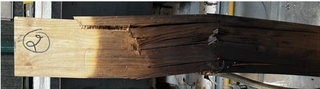
Figure 125 : Mode de rupture du poteau  $S_5$  chauffé à 250°C pour une durée de 60 minutes et testé à chaud
