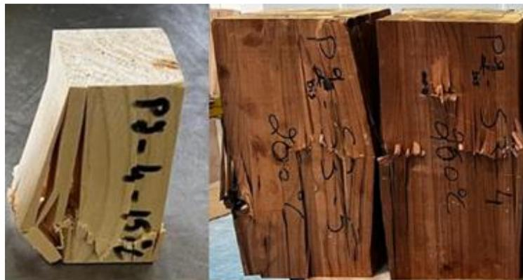
Figure 87 : Modes de ruptures des échantillons en compression pour des températures supérieures à 150°C
