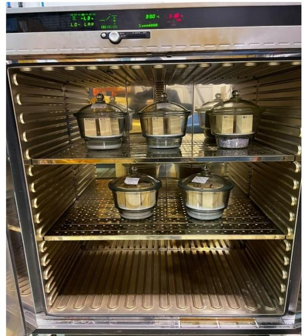
Figure 43 : Conditionnement des échantillons du bois lamellé-collé à 60°C dans une étuve à température contrôlée
