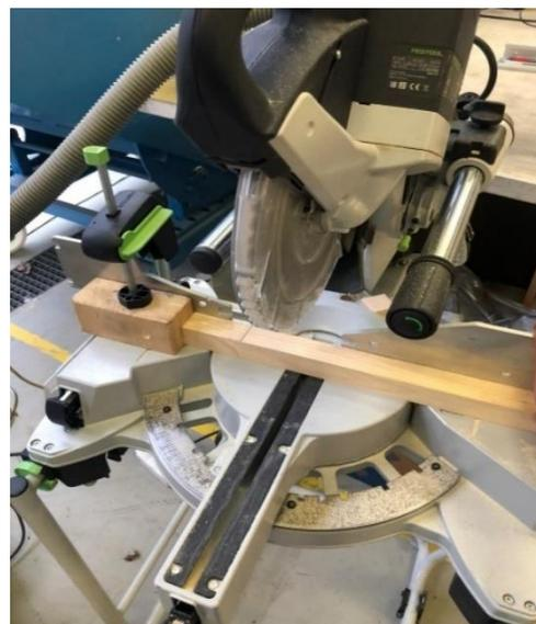
Figure 37 : Scie à onglet utilisée pour la découpe des éprouvettes  $S_0$  de bois de sapin
