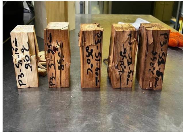
Figure 98 : Modes de rupture à 250°C pour la section S<sub>1</sub>
