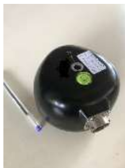
Figure 4 : Accéléromètre basse fréquence et haute sensibilité
