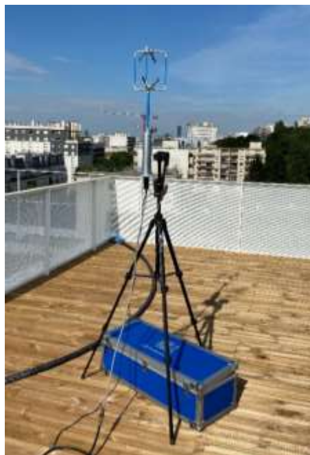
Figure 7 : L'anémomètre au sommet du bâtiment
