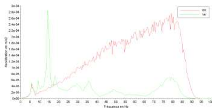
Figure 34 : FFT au rez-de-chaussée et au 1 er étage lors de l'essai au marteau dans la salle 0-1
