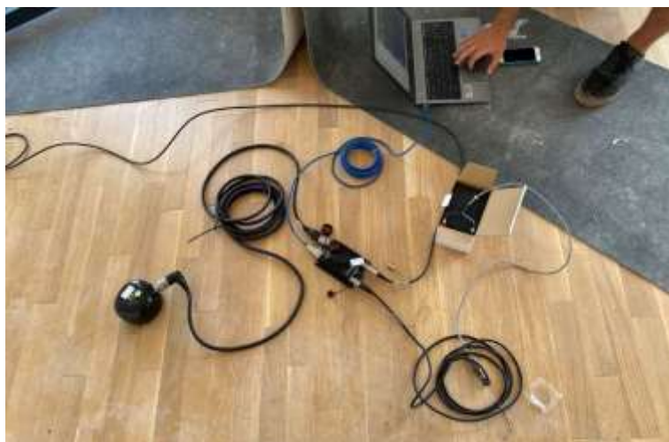
Figure 1 - Accéléromètres de mesures connectés à sa batterie et au système d'acquisition. Deux accéléromètres étaient fixés respectivement aux fondations et au dernier étage du bâtiment
