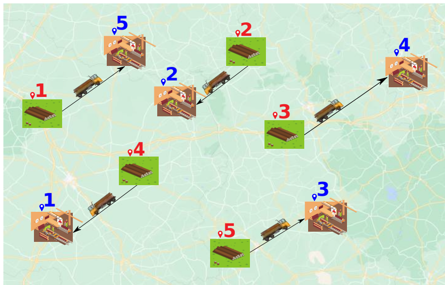
FIGURE 4.1 – Illustration d’une seule permutation pour un transport optimal entre l’ensemble des peupleraies et des industries de transformation selon la formulation de Monge. Les points rouges représentent les lieux de départ (les peupleraies) et les points bleus correspondent aux points de destination (les industries de transformation).
