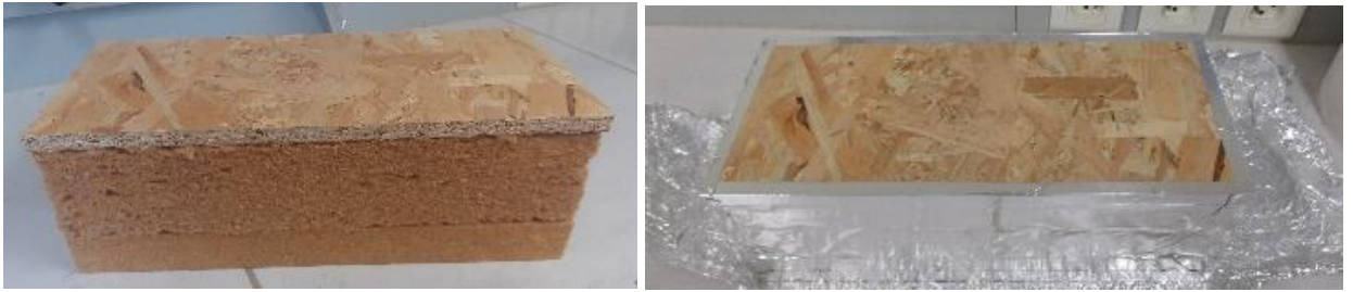
Photo 2 : Exemple de modèle réduit de mur ossature bois de type 10 (voile travaillant en panneau OSB, isolant en panneau en fibres de bois, écran rigide en fibres de bois) avant et après colmatage des parties non émissives
