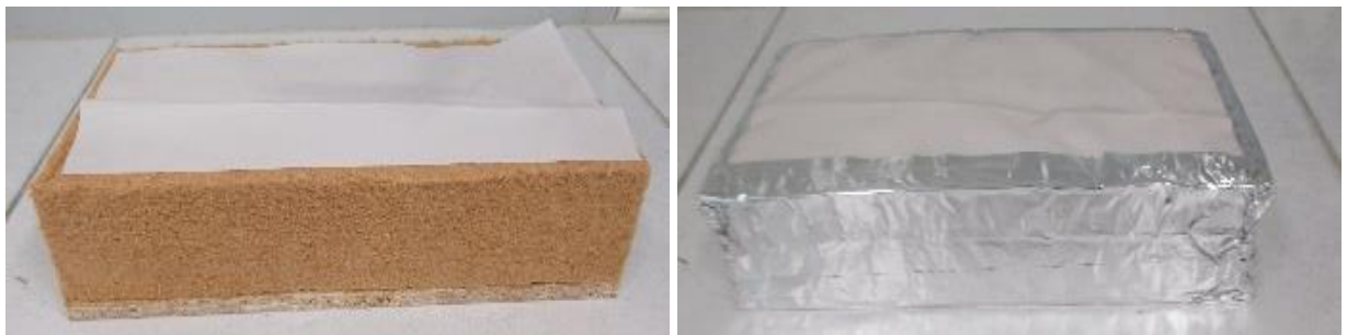
Photo 1 : Exemple de modèle réduit de mur ossature bois de type 1 (voile travaillant en panneau OSB, isolant en fibres de bois, film pare vapeur de faible perméabilité) avant et après colmatage des parties non émissives
