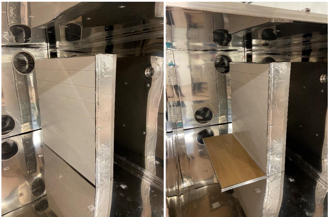
Photo 5 : Exemple de maquette de mur ossature bois de type 1, avec et sans revêtement de sol, en chambre d'essai d'émission de 4,8 m 3
