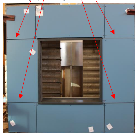
Photo 4 : Maquette FOB avec baie et revêtement extérieur en panneaux HPL
