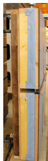
Photo 8 : Maquette d'essai vue de côté avec revêtement en panneaux HPL
