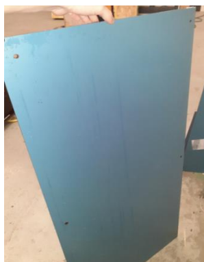
Photo 9 : Contrepement des panneaux HPL
