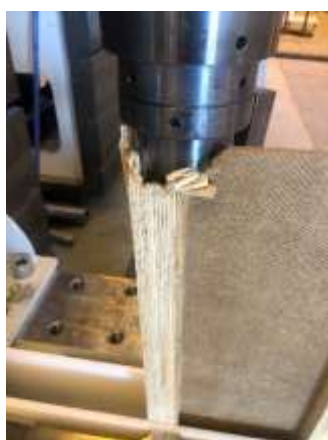
Photo 24 Poinçonnement de la membrure sous vérin en chargement excentré
