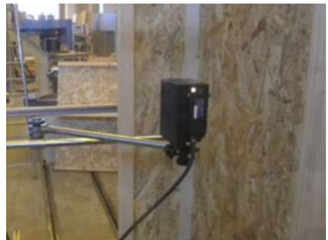
Photo 10 Capteur de déplacement dans le plan du mur
