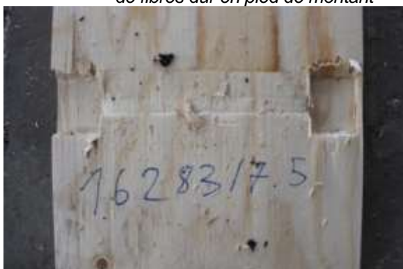
Photo 30 Enfoncement poutre en l'âme OSB dans traverse sous chargement centré
