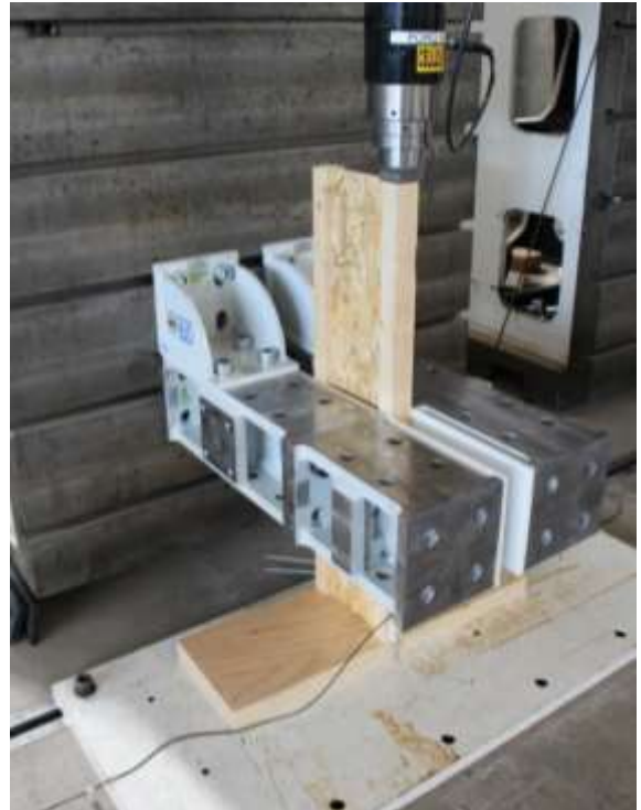
Photo 19 Montage d'essai avec chargement excentré
