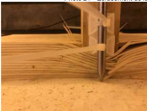
Photo 22 Ecrasement de la traverse au droit de la membrure chargée
