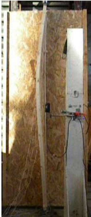
Photo 14 Flambement par flexion-torsion poutre en I 240 mm
