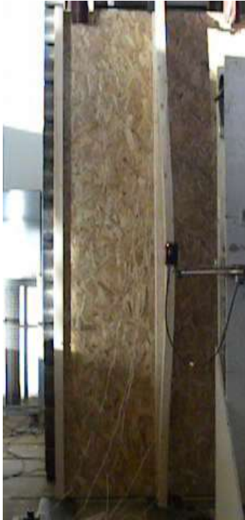
Photo 11 Flambement par flexion-torsion poutre en I 240 mm
