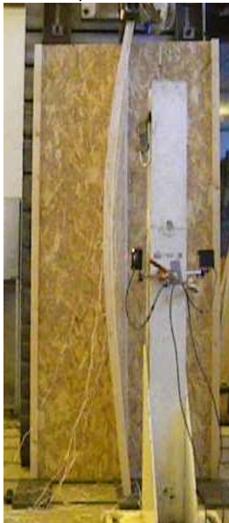
Photo 13 Flambement par flexion-torsion poutre en I 450 mm
