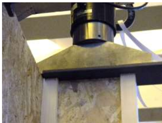
Photo 2 Plaque de répartition du chargement centré
