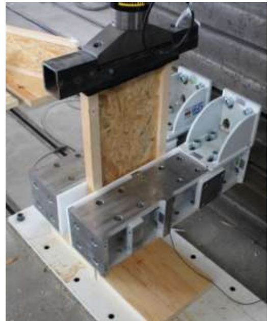
Photo 17 Montage d'essai avec chargement centré
