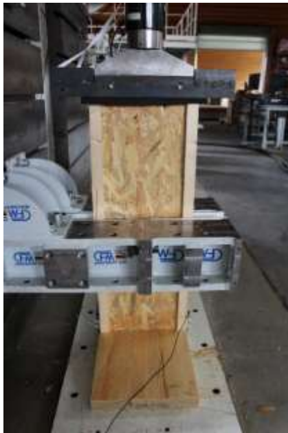
Photo 16 Montage d'essai avec chargement centré
