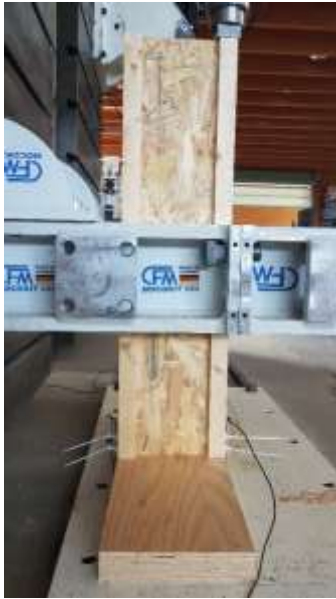
Photo 18 Montage d'essai avec chargement excentré
