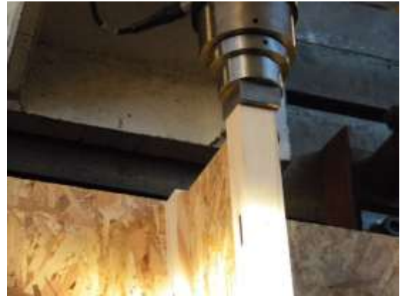
Photo 4 Plaque de répartition du chargement excentré sur montant côté intérieur
