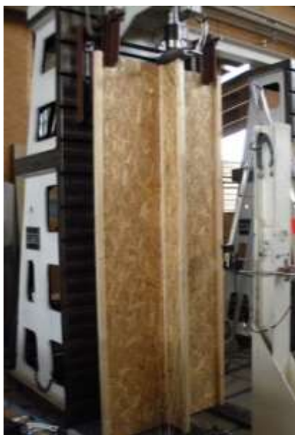
Photo 1 Montage d'essai avec chargement centré
