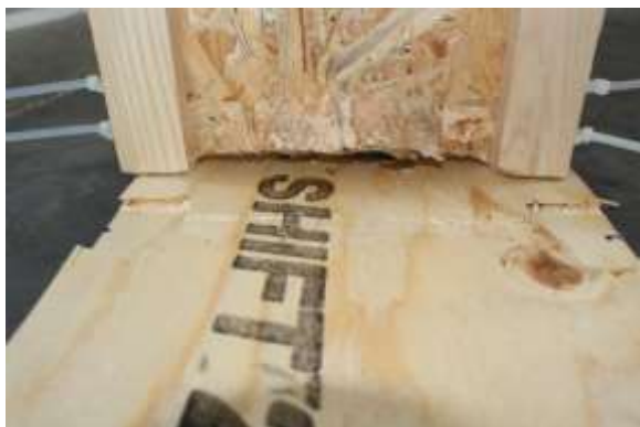
Photo 26 Ecrasement de l'âme OSB en pied de montant
