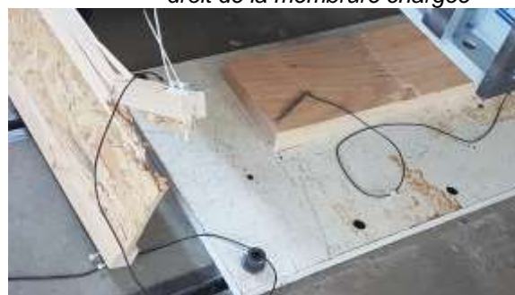
Photo 25 Rupture en pied de montant sous chargement excentré
