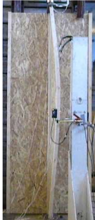
Photo 12 Flambement par flexion-torsion poutre en I 360 mm
