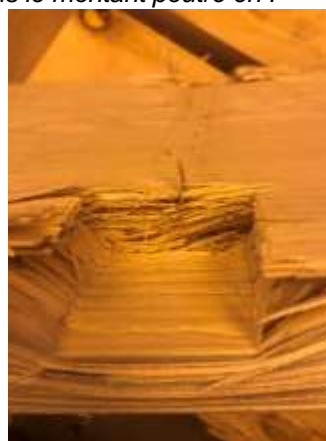
Photo 23 Ecrasement de la traverse au droit de la membrure chargée
