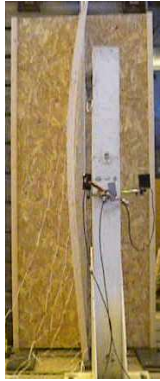
Photo 15 Flambement par flexion-torsion poutre en I 450 mm
