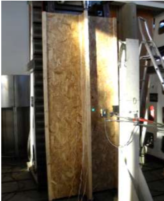
Photo 3 Montage d'essai avec chargement excentré
