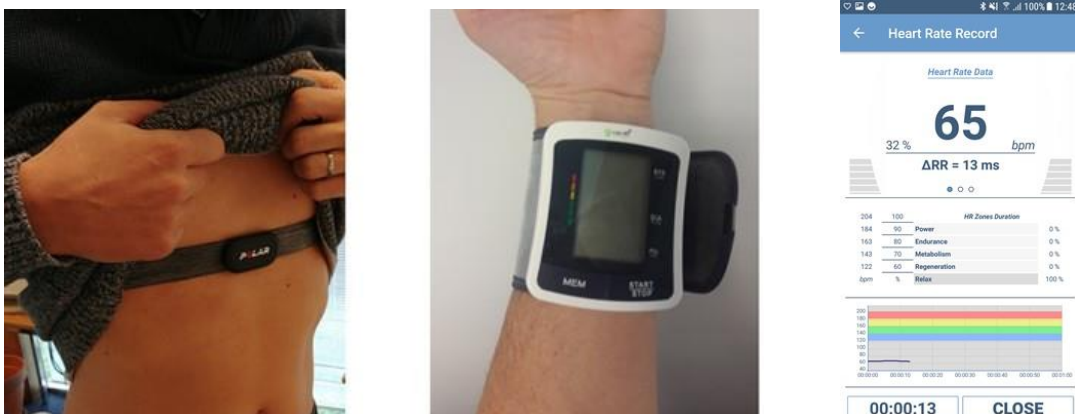
Figure 7 : Capteurs de mesures physiologiques et outil d'enregistrement de la VFC
