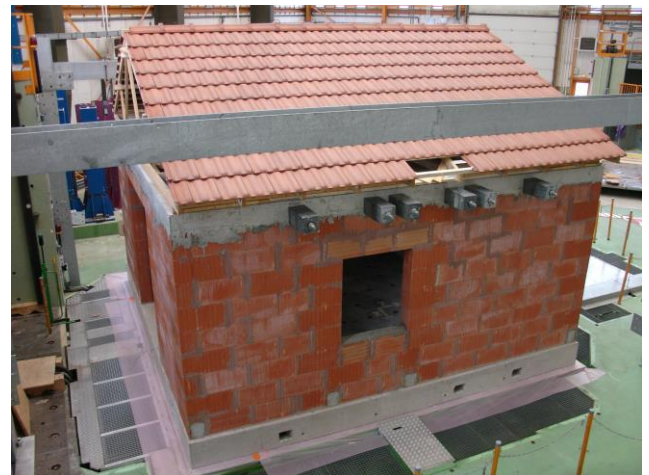
Essais sismiques sur maquettes de maisons à murs maçonnés et ossature bois avec toiture en charpentes industrialisées en bois.
