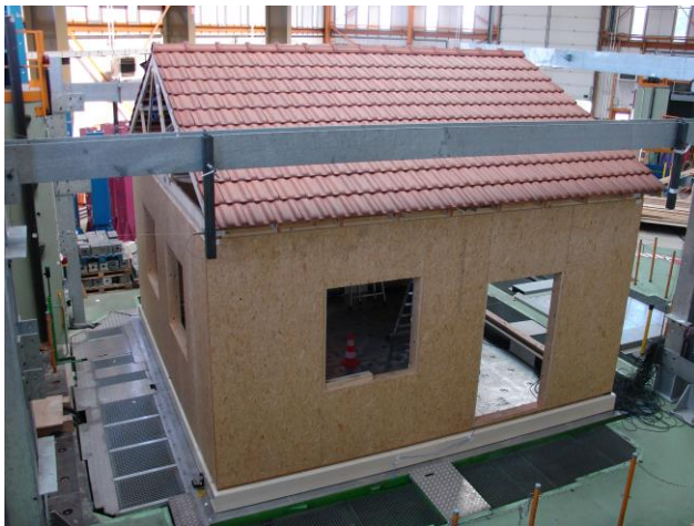
Essais sismiques sur maquettes de maisons à murs maçonnés et ossature bois avec toiture en charpentes industrialisées en bois.
