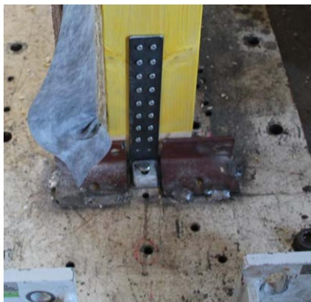
Figure B.17 : Équerre anti-soulèvement (exemple)
