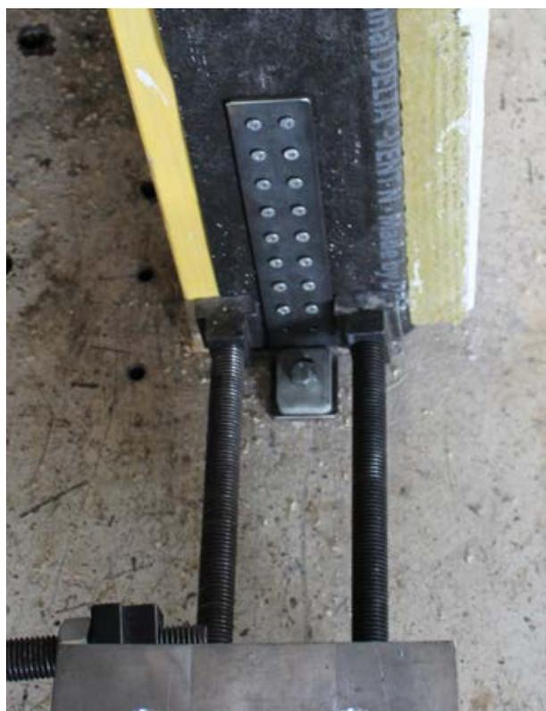
Figure B.16 : Butée réglable anti-glissement (exemple)
