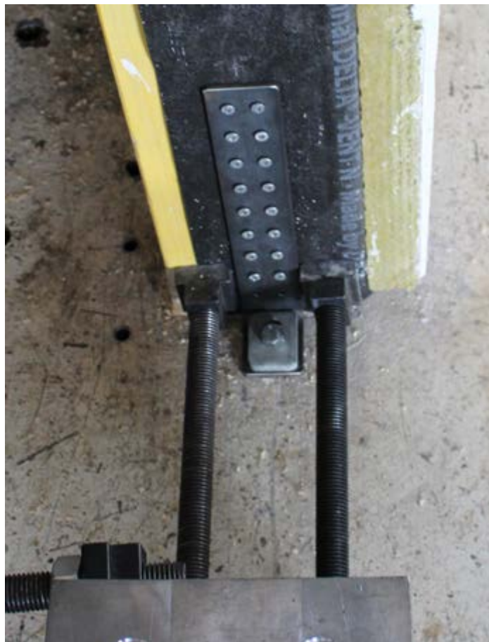
Figure B.15 : Butée réglable anti-glissement (exemple)
