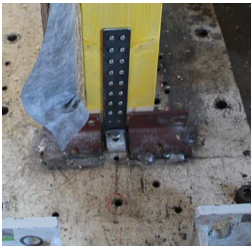
Figure B.16 : Équerre anti-soulèvement (exemple)
