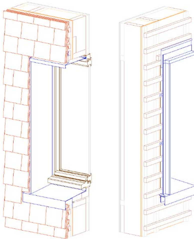
Figure 21 - Vue en perspective d'un principe d'intégration de menuiserie en applique intérieure avec pré-cadre bois.
