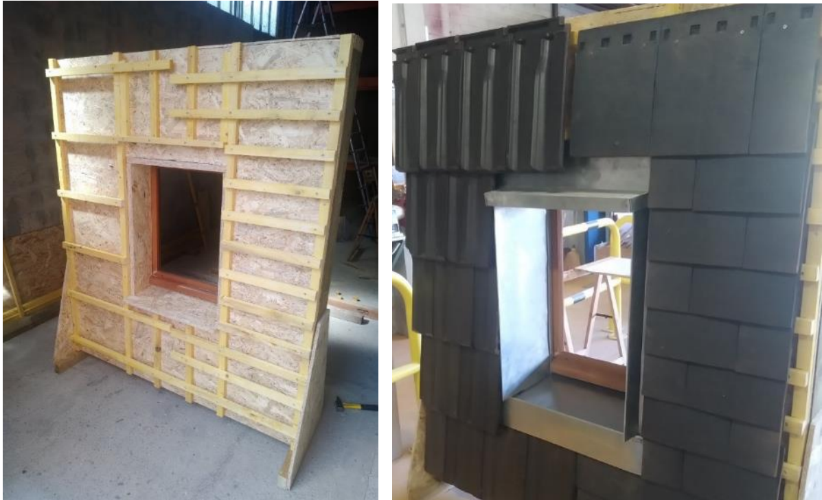
Photographies 1 : Maquette d'entourage de baie pour tuiles plates et tuiles à emboîtement. Ce traitement permet d'isoler la baie des contraintes liées
