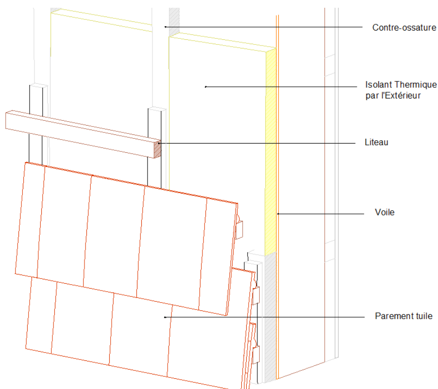
Figure 7 : Exemple d'ossature secondaire à trois réseaux (avec contre-ossature verticale)
