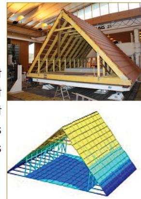
**« Les charpentes, dimensionnées pour un séisme de 1, ont résisté à un séisme de 3.»**
